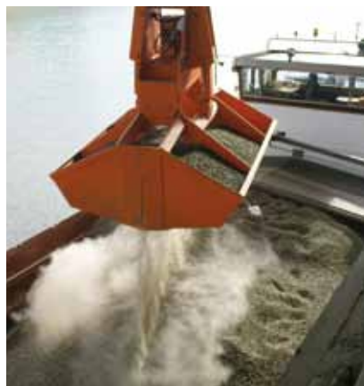
Der neue Elektro-Schalengreifer fasst acht Kubikmeter.
