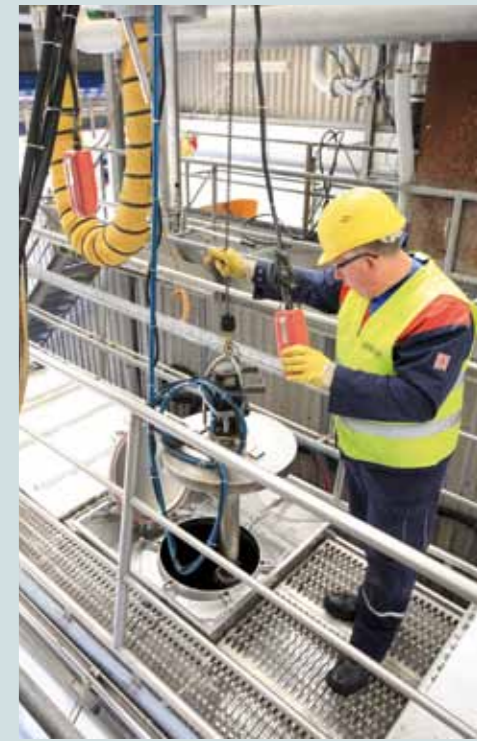
Das von Talke und Protec entwickelte System zur Absturzicherung passt sich jedem Behältertyp an.
