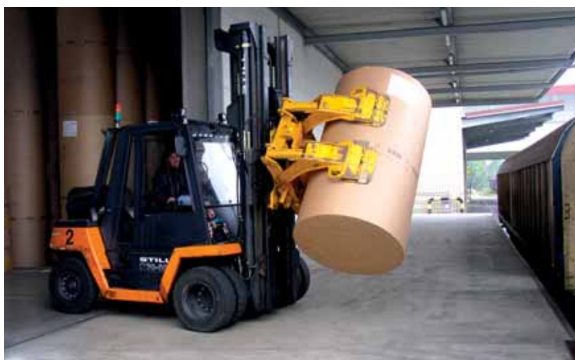
Mit Zangenstapler erfolgt die Entladung und Einlagerung
